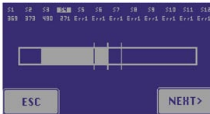
Figure 8 : Ajustement de la tension du câble n°3
