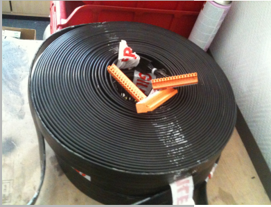
Filerie avec précablage total en gaine - cabine - machinerie
