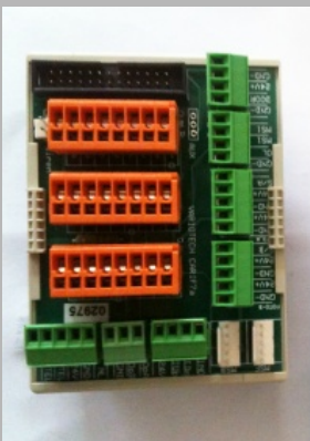
Module toit de cabine pour réduire et faciliter le câblage dans la boîte d'inspection et de raccordement
